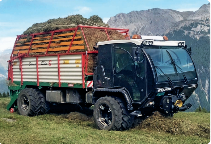
Mit Radstand 3950 mm passt auch ein massgeschneidertes Ladevolumen bis 39 m³.
