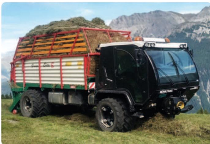
Mit Radstand 3950 mm passt auch ein maßgeschneidertes Ladevolumen bis 39 m³
