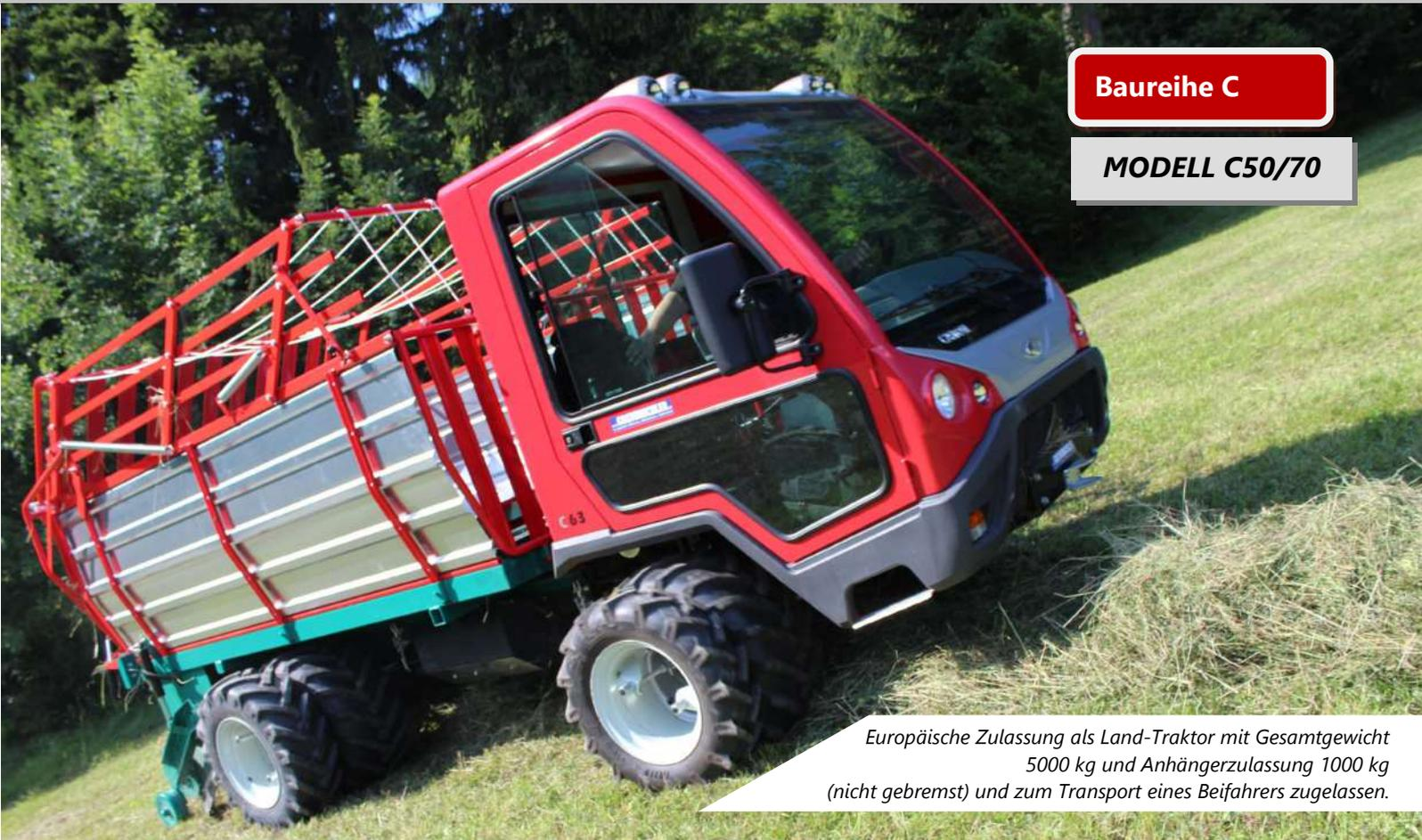
Europäische Zulassung als Land-Traktor mit Gesamtgewicht 5000 kg und Anhängerzulassung 1000 kg (nicht gebremst) und zum Transport eines Beifahrers zugelassen.
