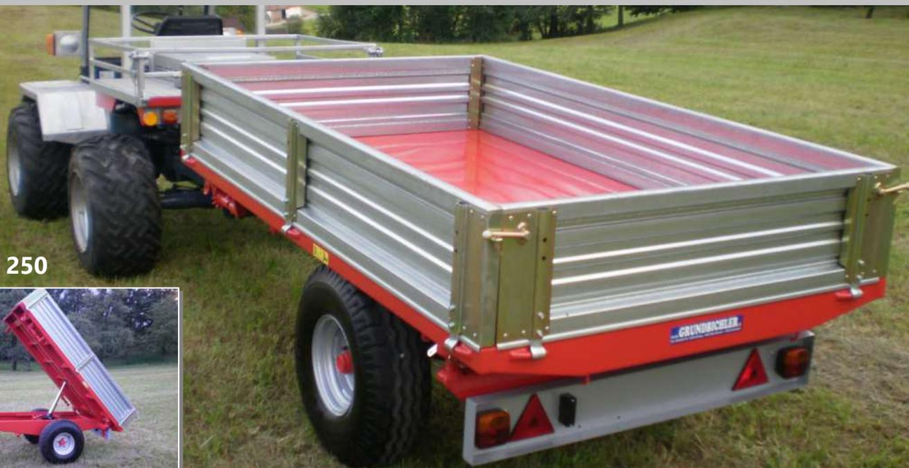
**Typ RT: Anhänger mit hydraulischem Dreiseiten-Kippantrieb**
