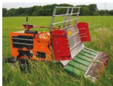
Die RoboFlail Vario Modelle sind dank der universellen Dreipunktaufnahme äußerst flexibel einzusetzen. Sie bieten für verschiedenste Arbeiten im Forst-, Kommunal- oder Grünflächenpflegebereich Komfort, Sicherheit und Effizienz. Mit der funkgesteuerten, stufenlos einzeln verstellbaren Spurbreite werden Arbeiten selbst in extrem anspruchsvollem Gelände möglich.
