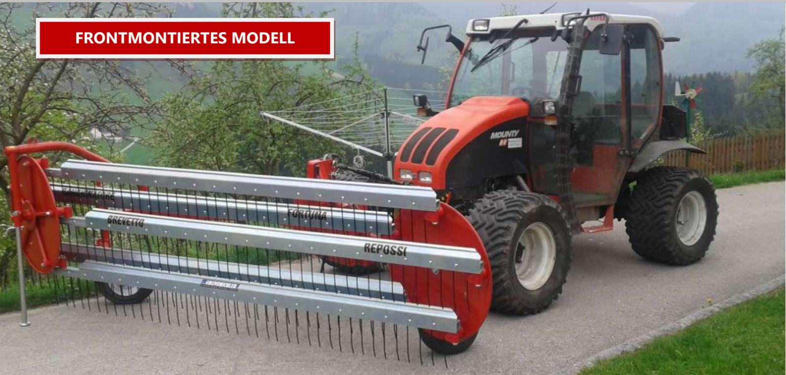
**Mod. 90/5 und 90/5 XL mit 5 Haspeln** - Geeignet für Traktoren und Geräteträger mit vorderer Hubeinrichtung. Ausgestattet mit unabhängiger Hydraulikanlage und an die Zapfwelle kuppelbarer Pumpe oder fix montierter Pumpe mit Antrieb über Gelenkwelle, die die Haspelrotation bewirkt. Pirouettierende Ballonräder über Gewindespindel höhenverstellbar.
