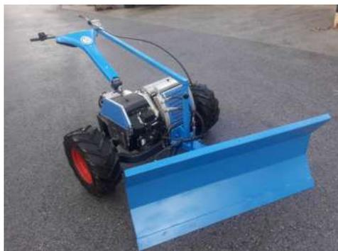
1,50 m mechanisch oder hydraulisch mit Gummischürfleiste
