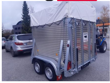
VA 282 (NR 18064) HzGG 2600 kg / Nutzlast 1790 kg / Reifen 14" Aufbau ALU tandem, auflaufgebremst, ohne Boden mit Planengestell inkl. Hochplane 450mm € 8.866,00 inkl. MwSt.
