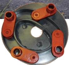
Mit **4 gesteuerten Zinkenreihen** wird mit geringem Kraftaufwand Silagefutter sauber und schonend aufgenommen. Mit einem exzentrisch gesteuertem Pick-Up ist es möglich, dass die Zinken am Ende vom Pick-Up, gerade angezogen werden und es somit keine Verwicklungen gibt. Diese bewährte Bauart wird bei Ladewagen und Pressen angewandt.
