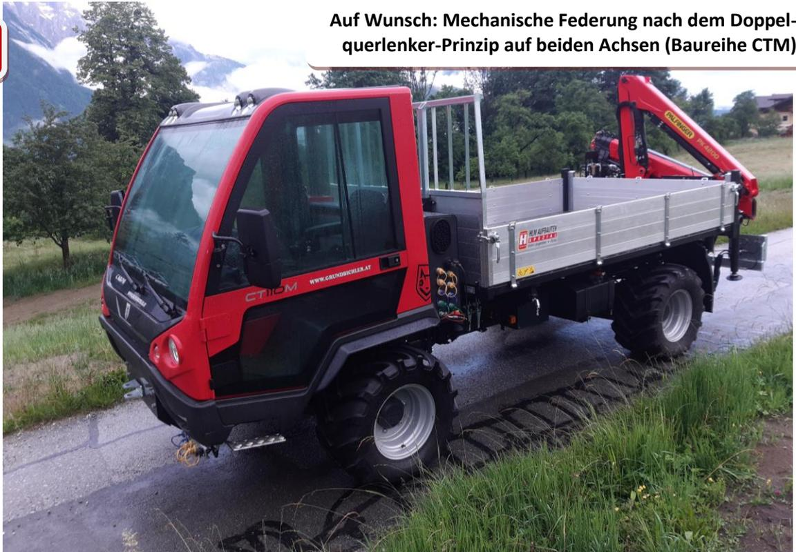
Auf Wunsch: Mechanische Federung nach dem Doppelquerlenker-Prinzip auf beiden Achsen (Baureihe CTM)
