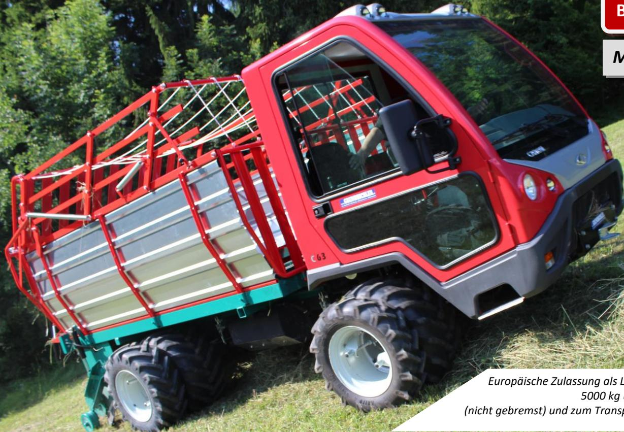
*Europäische Zulassung als Land-Traktor mit Gesamtgewicht 5000 kg und Anhängerzulassung 1000 kg (nicht gebremst) und zum Transport eines Beifahrers zugelassen.*
