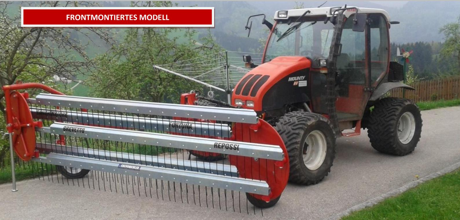
**Mod. 90/5 und 90/5 XL mit 5 Haspeln** Geeignet für Traktoren und Geräteträger mit vorderer Hubeinrichtung. Ausgestattet mit unabhängiger Hydraulikanlage und an die Zapfwelle kuppelbarer Pumpe oder fix montierte Pumpe mit Antrieb über Gelenkwelle, die die Haspelrotation bewirkt. pirouettierende Ballonräder über Gewindespindel höhenverstellbar.
