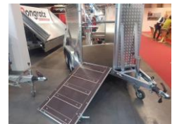
VA 282 (NR 18064) HzGG 2600 kg / Nutzlast 1790 kg / Reifen 14" Aufbau ALU tandem, auflaufgebremst, ohne Boden mit Planengestell inkl. Hochplane 450mm
