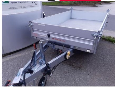
RK 2600/15 T-AL (NR 17517) HzG 2.500 kg / Nutzlast 1947 kg Bereifung: 195/50R13 C ALU, tandem, auflaufgebremst, Kippfunktion, Elektro- Kombipumpe, Batterie, 13-poliger Lichtstecker mit Ldekabel zur Batterie € 5.529,00 inkl. MwSt.
