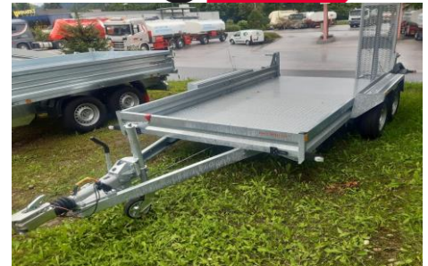
Pongratz PMT 300/16 T (NR 18871) HzGG 3500 kg / Nutzlast 2739 kg Stahl, Tandemachser, Bereifung 195/50R13C, auflaufgebremst, Automatikstützrad, 2 Auffahrschienen stufenlos verschiebbar, Boden verzinktes Stahl-Tränenblech, 6 Zurrpunkte 3030x1600x260 mm € 6.759,00 inkl. MwSt.
