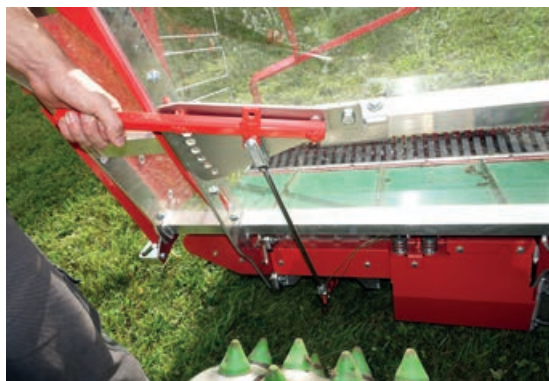
... mit einem Handhebel und einer Lochleiste in der Höhe verstellen.
