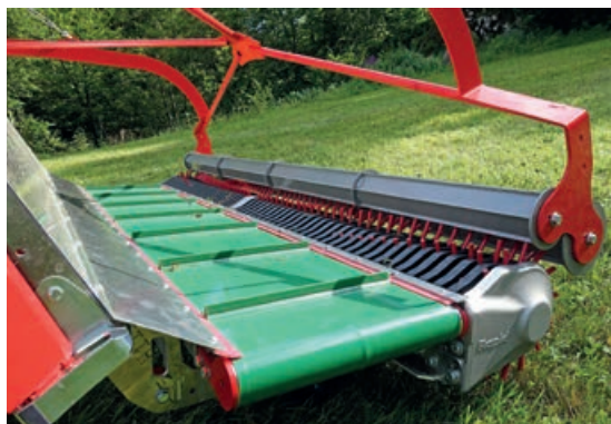
Das von der Pick-up aufgenommene Futter wird vom Förderband mit Räumleisten aktiv zur Seite transportiert.
