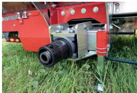
Der An- und Abbau mit der bekannten Schnellkupplungsfunktion, bestehend aus Anbaustutzen, Verriegelbolzen und Abstellstütze, ist einfach.
