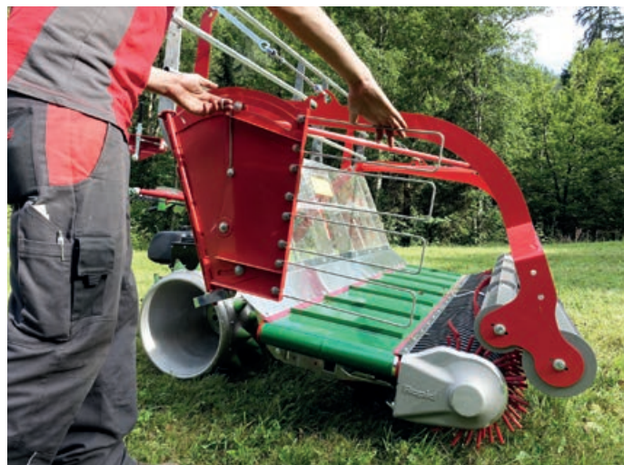
Die optionalen Zinkenabweiser haben zwei Stellungen: Abweis- und Transportfunktion.
