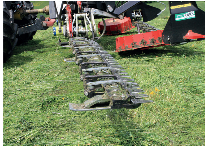
Mit den geschraubten Gleitkufen in der Höhe von 4–12 cm lässt sich die Schnitthöhe variieren.
