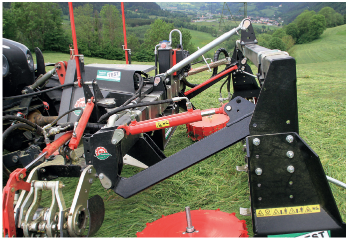
Alle Mähantriebe und Hydraulikzylinder werden von der bordeigenen Hydraulik mit Öltemperaturüberwachung und Ölkühler versorgt.
