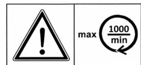
**Maximale Drehzahl und Drehrichtung der Gelenkwelle am Schlepper 1000 min<sup>-1</sup>.**
