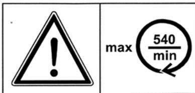
Maximale Drehzahl und Drehrichtung der Zapfwelle am Schlepper 540 min<sup>-1</sup>.
