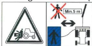
35. Der Aufenthalt zwischen der Last und der Winde und im gefährlichen Dreieck zwischen der Winde, der Umlenkrolle und der Last während des Ziehens ist verboten! Siehe Bild 7.
