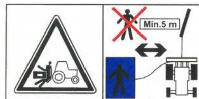
14. Zwischen dem Schlepper und der Winde darf sich niemand aufhalten, ohne dass der Schlepper vor dem Fortbewegen durch die Bremse oder den Unterlegkeil gesichert wird.
