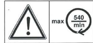
**Maximale Drehzahl und Drehrichtung der Zapfwelle am Schlepper 540 min-1.**
