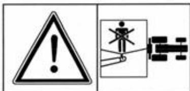
14. Zwischen dem Schlepper und der Winde darf sich niemand aufhalten, ohne dass der Schlepper vor dem Fortbewegen durch die Bremse oder den Unterlegkeil gesichert wird.
