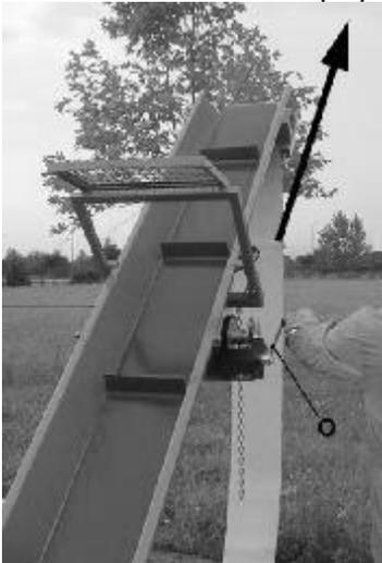
□□ Prüfen Sie, ob sich das Fallschutzgitter für die Stämme in gesenkter Stellung befindet.
