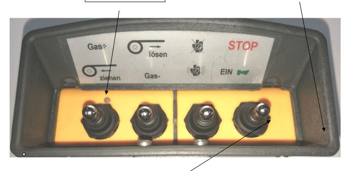
Zum Einschalten des Senders Taste 3 Sekunden nach hinten drücken Zum Ausschalten des Senders und aller Funktionen nach vorne drücken
