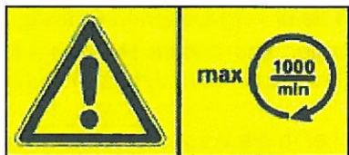
Maximale Umdrehungen der Kardanwelle.
