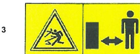
Bei dem Antrieb des Mulcher besteht die Gefahr der Auswurf! Behalten Sie einen sicheren Abstand von der Maschine.
