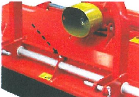
*Bild 14: Mechanische Verschlussblockade*
