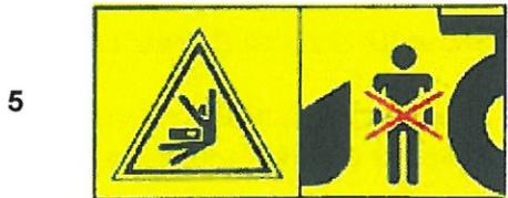
Bei dem Anhängen oder Betrieb des Mulchers kein Aufhalten in der Nähe der Maschine, oder zwischen der Maschine und dem Schlepper.
