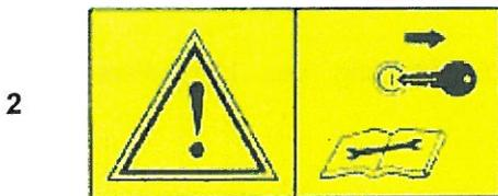
Vor dem Beginn der Reparatur- und Wartungsarbeiten stellen Sie den Betriebsmotor ab und ziehen Sie den Zündschlüssel aus.
