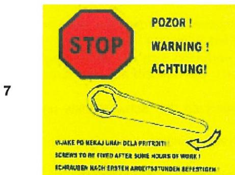
Nach 10 Arbeitsstunden alle Verschraubungen kontrollieren.
