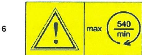
Maximale Umdrehungen der Kardanwelle bei Grund-Fabrikeinstellung.
