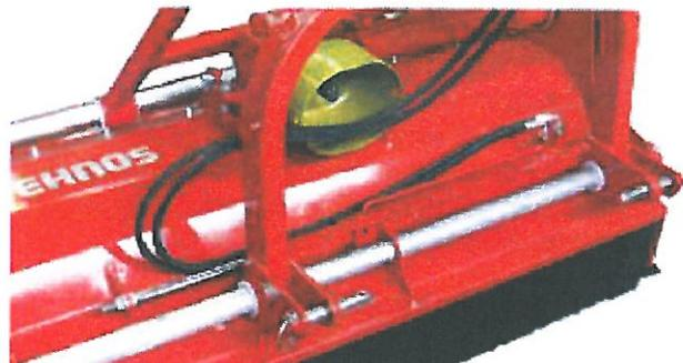
*Bild 15: Hydraulischer Verschluss*
