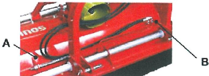
Bild 22: Hydraulischer Zylinder
