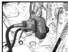
⇒ Beim Abstellen der Maschine Pumpe auf denvorgesehenen Support oder Bolzen des 3° Punkts stecken.
