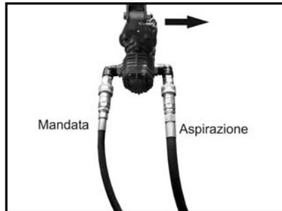
Bei linksdrehender Zapfwelle (Gegen Uhrzeigersinn) Schläuche so verbinden: Ansaugen (großer  $\frac{3}{4}$ " Schlauch) links Drücken (kleiner  $\frac{1}{2}$ " Schlauch) rechts.
