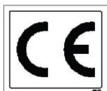
Das vom Hersteller anzubringende CE-Zeichen dokumentiert nach außen hin die Konformität der Maschine mit den Bestimmungen der Maschinenrichtlinie und mit anderen einschlägigen EG-Richtlinien.
