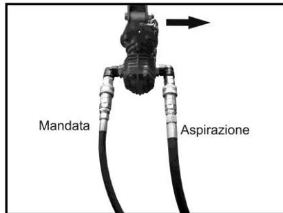
Bei linksdrehender Zapfwelle (Gegen Uhrzeigersinn) Schläuche so verbinden: Ansaugen (großer 3/4" Schlauch) links Drücken (kleiner 1/2" Schlauch) rechts.
