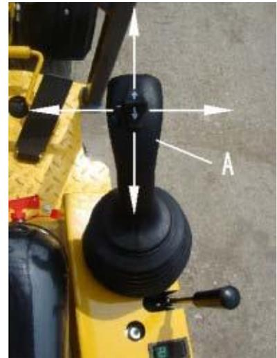
Die Arbeitsgeschwindigkeit hängt von der Leistung des Motors und der Bedienung des Joysticks ab (mehr Neigung, mehr Leistung).
