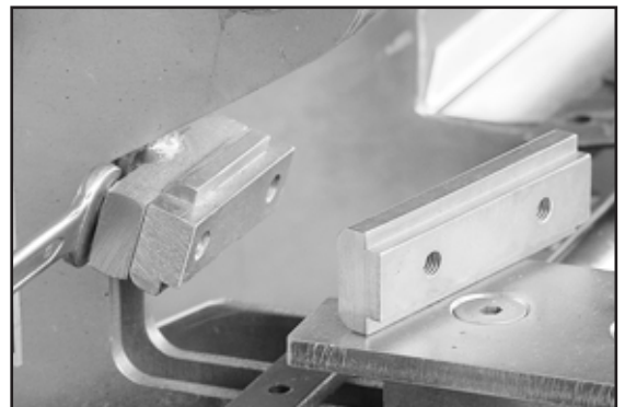
8. Einstellung Abscherklinge Hier auf Parallelität achten, Abscherklinge darf nicht an Messerrücken anstehen.
