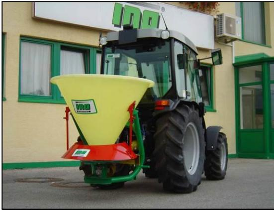
Den Zentrifugalstreuer an die hintere Dreipunkthydraulik des Schleppers anbauen.
