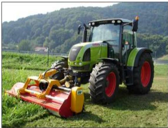
Arbeitsgeschwindigkeit des Gerätes ist abhängig vom Schnittgut. Optimale Arbeitsgeschwindigkeit beträgt von 3-8 km/h.
