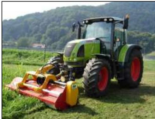
Arbeitsgeschwindigkeit des Gerätes ist abhängig vom Schnittgut. Optimale Arbeitsgeschwindigkeit beträgt von 3-8 km/h. Bei größerer Mulchmasse dem entsprechen die Fahrgeschwindigkeit verringern, damit der rutsch der Riemen verhindert wird.
