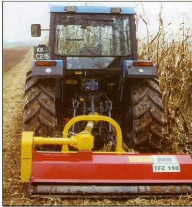
Arbeitsgeschwindigkeit des Gerätes ist abhängig vom Schnittgut. Bei großer Mulchmasse die Arbeitsgeschwindigkeit verringern. Optimale Arbeitsgeschwindigkeit beträgt von 3-8 km/h.
