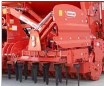
Parallelogrammgeführte Seitenschilder (Serie bei DC-Classik, DM-Classik, DM-Rapido)
