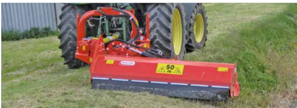
GIRAFFA XL SE mit außenliegendem Getriebe
