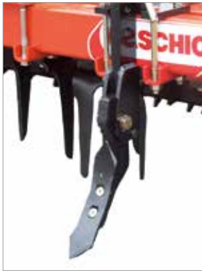
Spurlockerer mit Abscherschraube (Beipack, 2 Stück)
