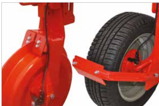
Stahl- oder Gummiräder mit Geschwindigkeitssensor
