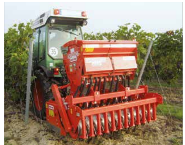
Mechanischer Antrieb über Walze
