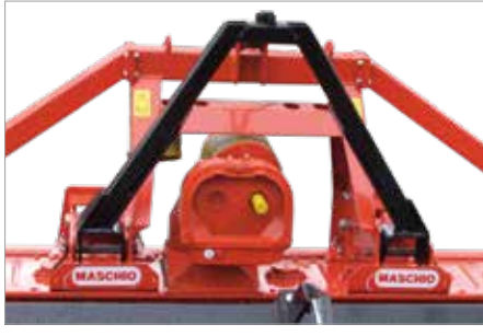
Aufsatteldreieck für pneumatische Drillmaschine (Fremdfabrikat), nicht passend für ORSO
