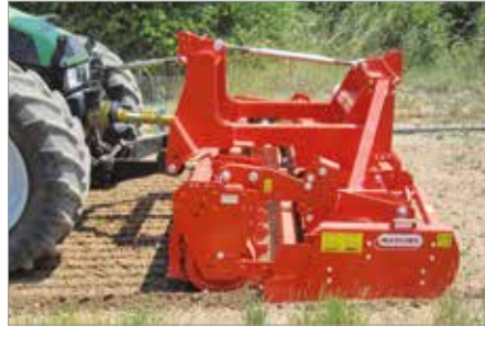
Frontanbaubock inkl. Walterscheid-Gelenkwelle für Front, Mindesthöhe Zapfwellenstummel am Schlepper = 770 mm
