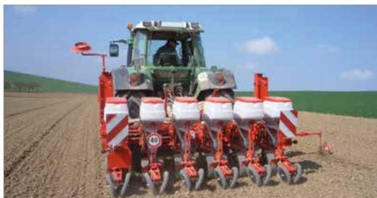
Arbeitsstellung bei 75 cm Reihenabstand (Abbildung zeigt aufpreispflichtiges Zubehör)
