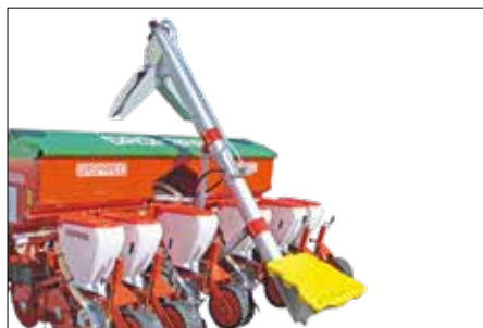
Düngerbefüllschnecke, hydr. (Reihenabstand ≥ 70 cm)
