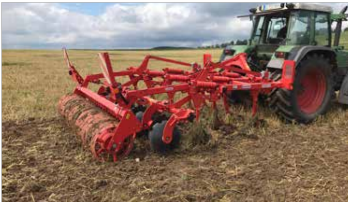
TERREMOTO 3 mit Scherbolzen in 4,0 m Arbeitsbreite
