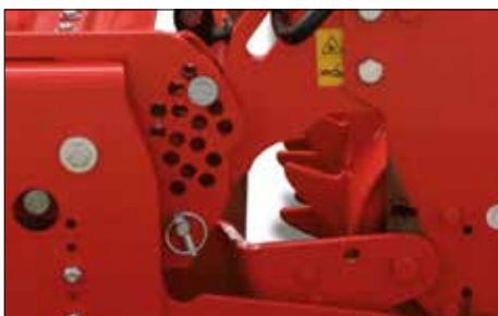
Seitliche Walzenaufnahme mit Bolzenverstellung der Walze
