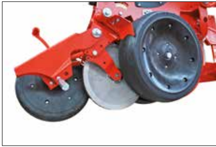
Inox-Zwischenandruckrolle ø 300 mm
