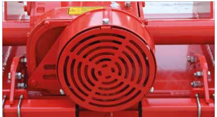
Ölbad-Wechselradgetriebe mit Luftkühlung
