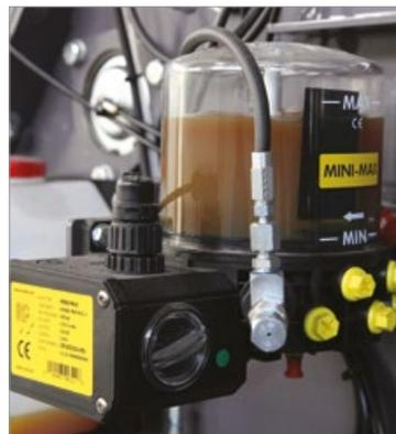
Automatische Zentralschmieranlage (optional)
