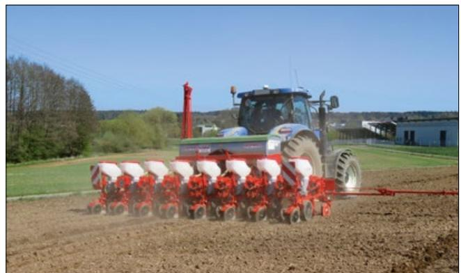
Pneumatische Einzelkornmaschine mit Teleskoprahmen. Transportbreite 3,0 m.
