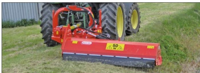
GIRAFFA SE mit außenliegendem Getriebe
