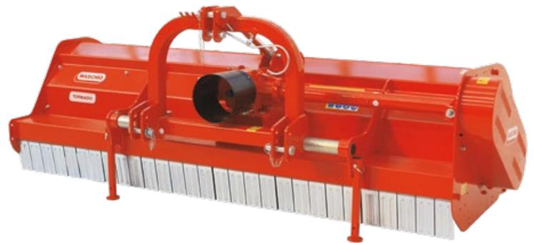
Mit **hydraulischer** Seitenausschwenkung und Neigungsverstellung.
