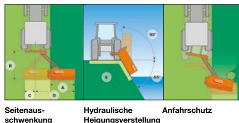
Seitenausschwenkung      Hydraulische Neigungsverstellung      Anfahrschutz
