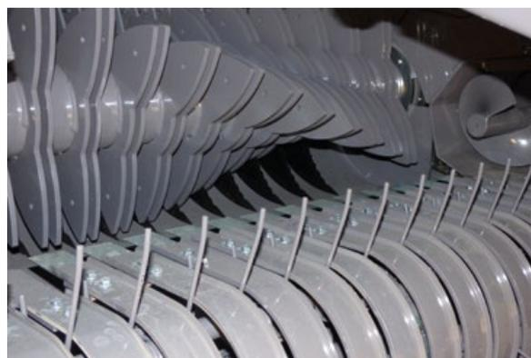
Schneidwerk mit Spiralrotor
