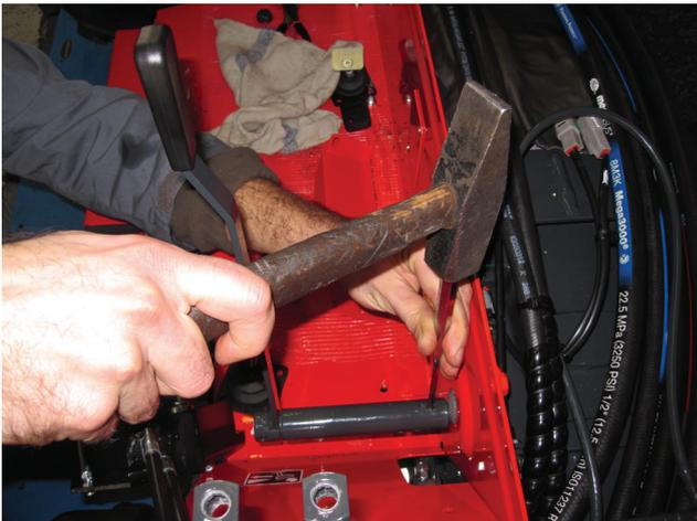
**21)** Den Hebel der PTO-Steuerung entfernen.
