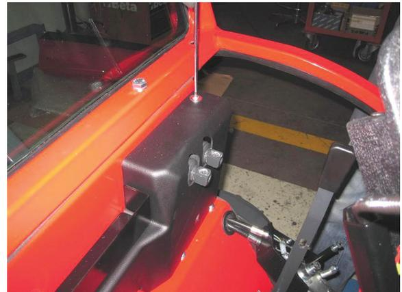
b - Die Schrauben lösen und die Abdeckung entfernen.
