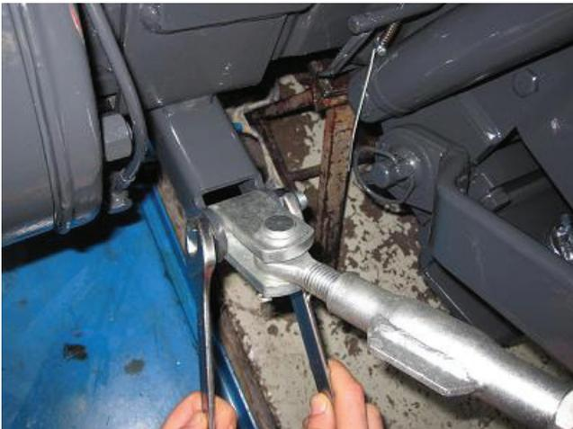
6) Die Zugbolzen der Unterlenker abziehen und die Hubstangen entfernen.
