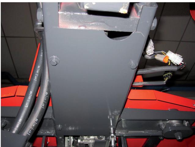
1) Die Schrauben lösen und die untere Schutzabdeckung abnehmen.
