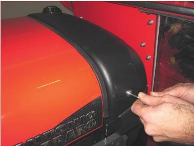
7) Die Schrauben abdrehen und den Tankdeckel entfernen.
