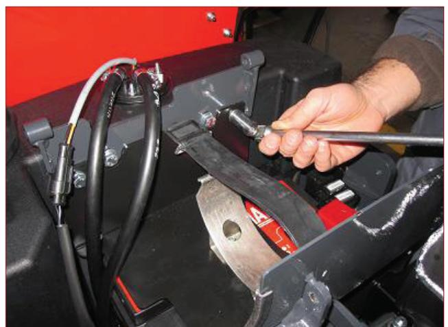
11) Die Schrauben abschrauben und die Halterung des Luftfilters entfernen.
