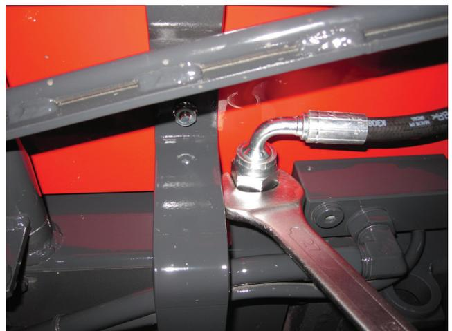
**15)** Alle Leitungen des Bypass-Ventils abschrauben.
