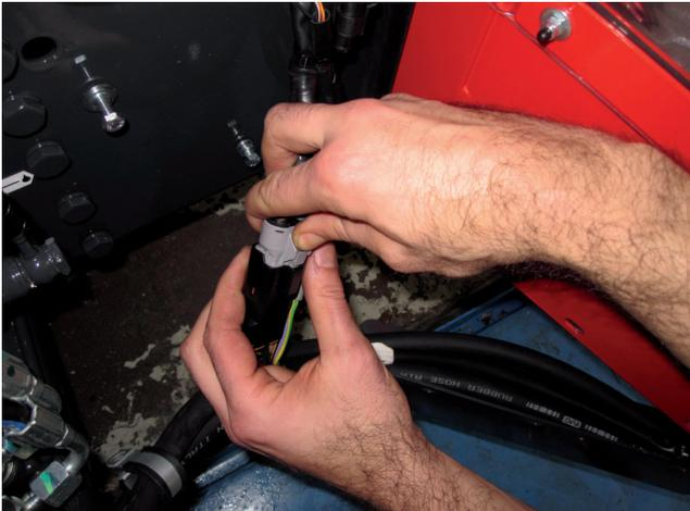
1) Die beiden Stromversorgungsanschlüsse der Kabine abziehen.
