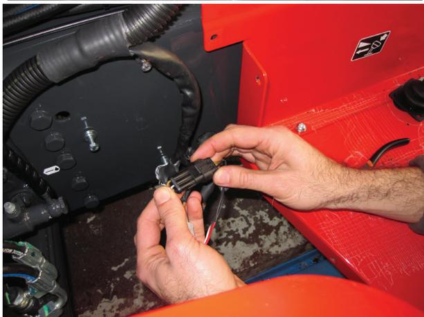
**17)** Die zentralen Elektroanschlüsse abziehen.
