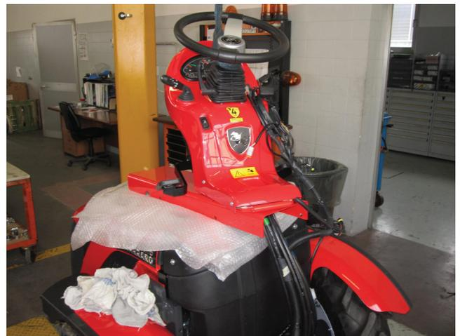
**19)** Das Lenkrad anseilen und an einem Werkstattkran einhängen. Die gesamte Einheit anheben und auf der angemessen geschützten Motorhaube ablegen.
