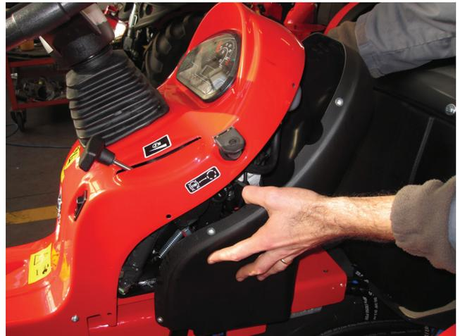
**13)** Die Armaturenabdeckung abschrauben und entfernen.
