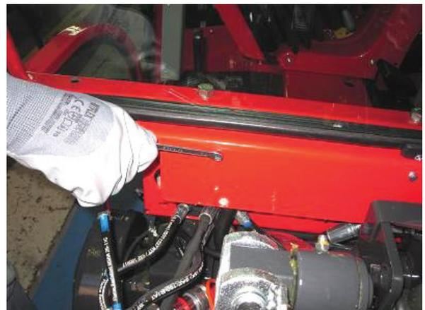
c - Die Schrauben abschrauben und die hintere Abdeckung entfernen.
