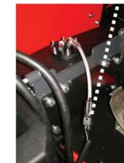
Pumpe Klimaanlage, Kraftstoffpumpe X19 X41
