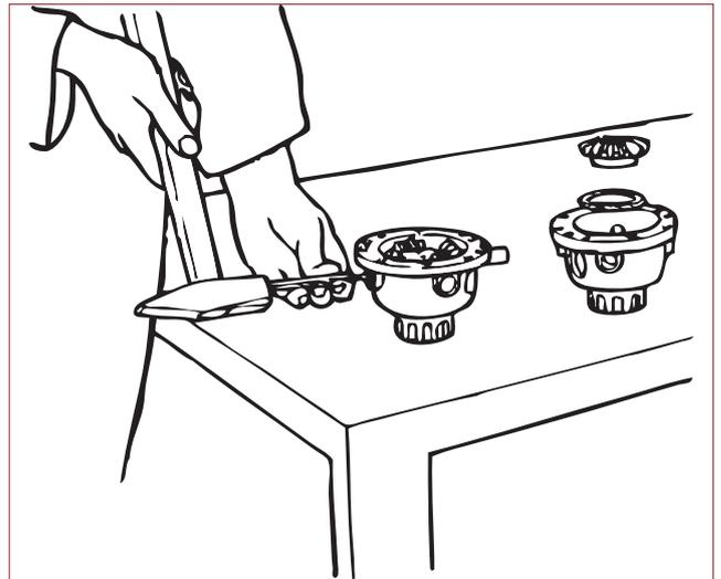
4) Die Bolzen entfernen und Ausgleichskegelräder, Anlaufscheiben, Passscheiben und Planetengetriebe sicherstellen.
