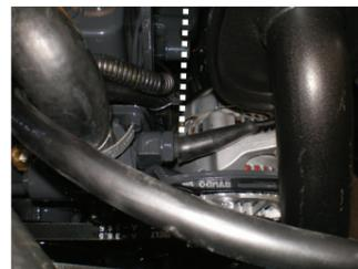
Magnetventil Leerlauf/ Fahrtbetrieb X16
