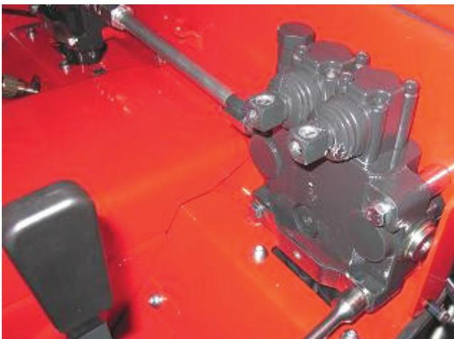
**f** - Die Schrauben lösen und den linken Verteiler entnehmen.
