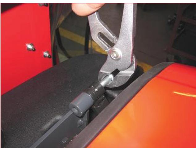
9) Die Motorhaube wieder schließen, die Arretierringe entfernen und die Bolzen herausziehen, danach die Motorhaube abnehmen.
