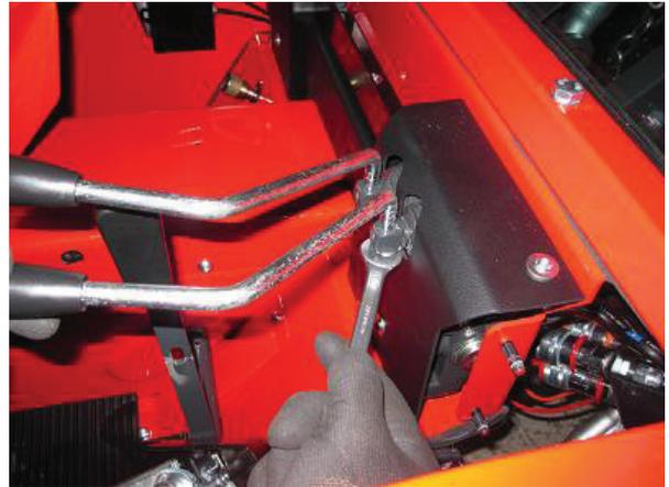
a - Die Muttern abschrauben und die Hebel an beiden Verteilern entfernen.
