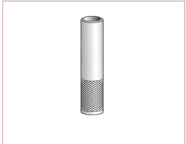
**AT 37981098** - Schlagorn zur Montage des Kegelrollenlagers.
