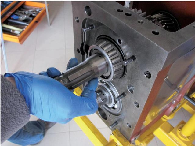
**(19)** Das Lager (C1) schmieren und die Zapfwelle montieren.
