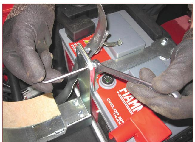
**11)** Die Schrauben abdrehen und den Luftfilterhalter und die Batteriehalteschiene entnehmen.
