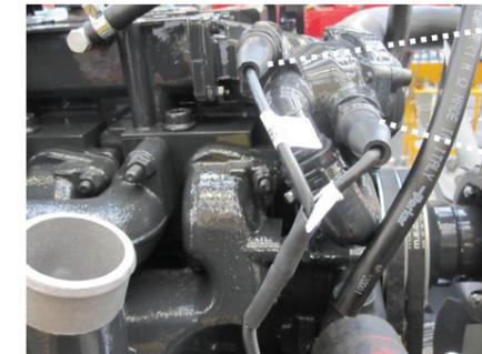
Wassertempersensor Motor X24
