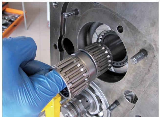
(18) Die Lager (C2) und (C3) mit dem Distanzring (D1) schmieren und montieren.
