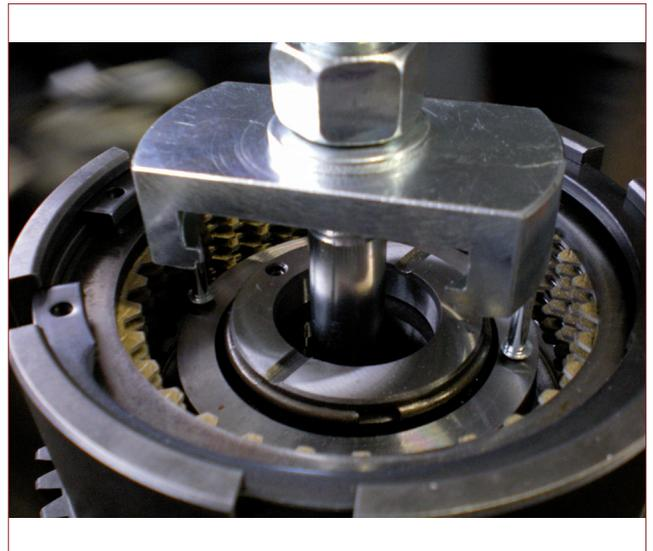
**(3)** Den Teller einsetzen und die Feder soweit spannen, dass der Sicherungsring herausgezogen werden kann. Den Teller abschrauben und die Feder beiseite legen.
