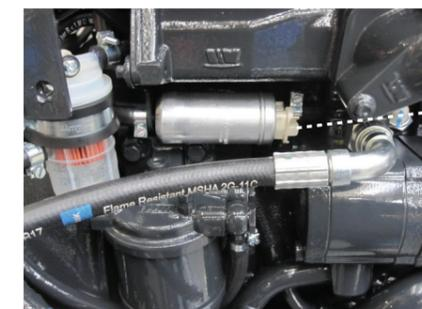
Kraftstoff-Elektropumpe X29.1 X29.2
