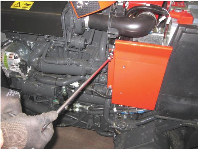
**6)** Die Schrauben abdrehen und die Seitenwände abnehmen.
