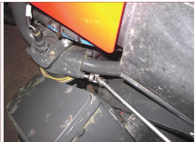
**16)** Einen Behälter unter die Ölfilter stellen und danach die Schrauben der Ansaugleitung abdrehen.
