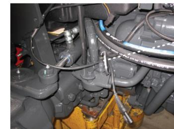
Druckwächter Hydraulikölfilter X20
