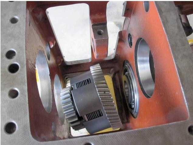
**(3)** Den Rollenkäfig (C11) schmieren und an der Zapfwellenkuplung montieren.
