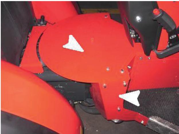
**(7)** Die Steuersäule in umgekehrte Fahrtrichtung drehen, die Schrauben lösen und die Schutzgehäuse der Leitungen und die vordere Gehäuseabdeckung herausziehen.
