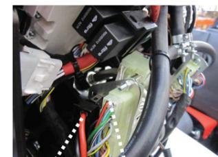
Verbinder anschluss an armaturenbrettleitung X1.1-X1.2
