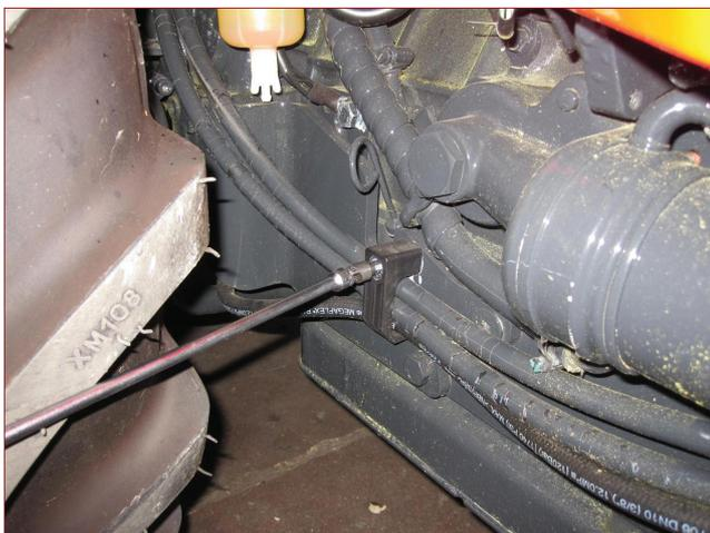
**21)** Die Schraube abdrehen und die Leitungssicherung abnehmen.
