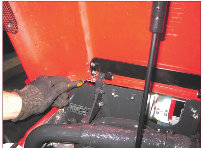
**9)** Die Arretierringe entfernen und die Bolzen herausziehen, danach die Motorhaube abnehmen.
