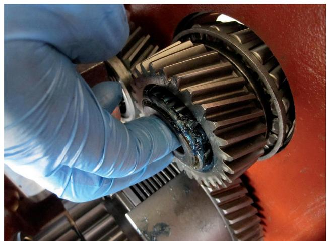
**(15)** Die Lager (C9) und (4) schmieren und montieren.
