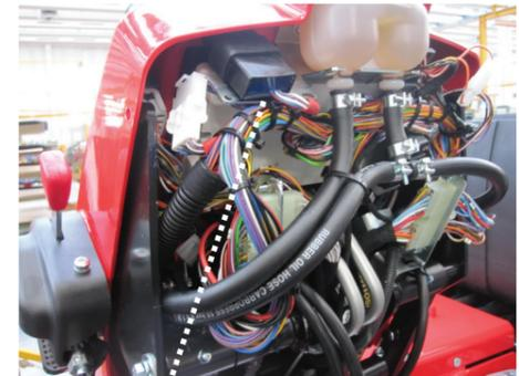
Steuergerät zum Einschalten der Zapfwelle X8
