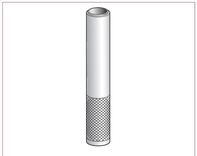
**AT 37981145** - Schlagdorn zur Montage von Kegelrollenlagern.
