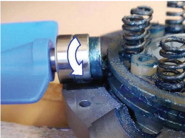
12) Die neuen Flügel mit dem Schieber nach unten in die Kolbennut einführen und im Uhrzeigersinn drehen. Der Nilos-Ring befindet sich im Inneren der Halterungsbohrung → ohne den Nilos-Ring (9) zu beschädigen.
