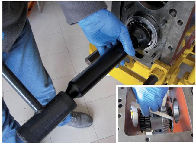
(6) Für die Montage die geeignete Ausrüstung verwenden. Um ein Herausrutschen der Zapfwellenkupplung während der Montage zu vermeiden, diese mit dem entsprechenden Werkzeug fest halten.
