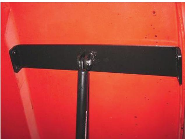
**8)** Die Motorhaube öffnen und den Befestigungsbolzen der Gasfeder an der Motorhaube entfernen.
