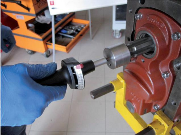
Unter Verwendung eines Drehmomentmessers und dem Adapter AT 37981132 überprüfen, ob der Drehwiderstand gleich
