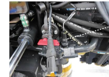
Druckwächter Hydraulikölfilter X20
