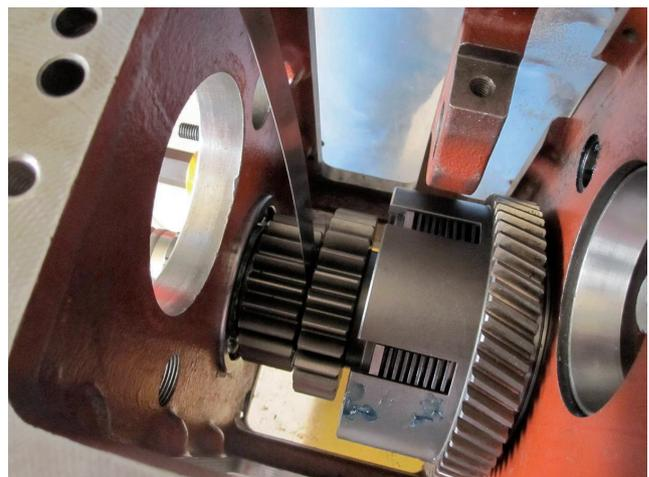
(7) Mit einem Dickenmesser überprüfen, ob das Spiel zwischen den beiden Zahnrädern 0,2 - 0,4 mm beträgt. Sollte das Spiel größer oder kleiner sein, auf die Nullstellung des Lagers (C7) einwirken, indem ein als Ersatzteil gelieferter Distanzring von 0,1, 0,2 mm eingesetzt oder entfernt wird.
