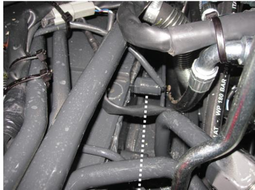
Schalter Kontrollleuchte Zapfwelle E X14
