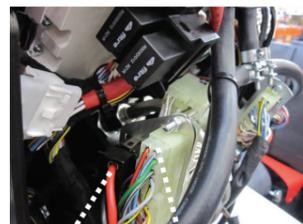
Verbinder anschluss an armaturenbrettleitung X1.1-X1.2
