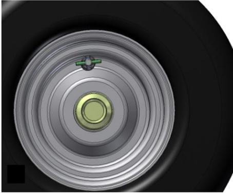
Abb. 43 Feststellbremse ausgekuppelt
