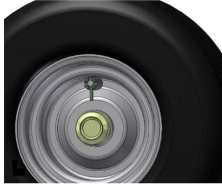
Abb. 44 Feststellbremse eingekuppelt
