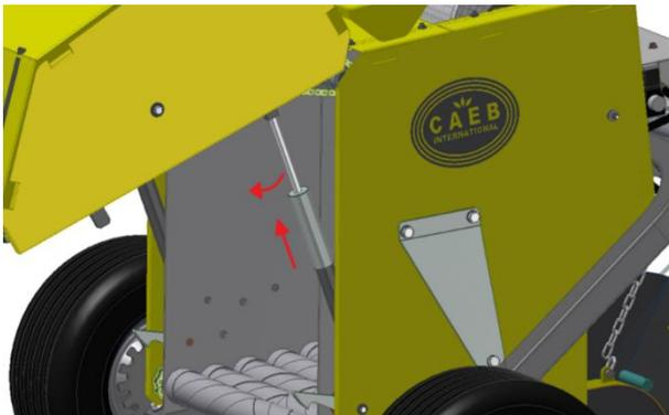
Abb. 10 Schließsicherung
