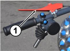
Der Totmann-Hebel (1) befindet sich am linken Fahrgriff der Antriebsmaschine.
