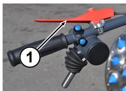
Der Totmann-Hebel (1) befindet sich am linken Fahrgriff der Antriebsmaschine.
