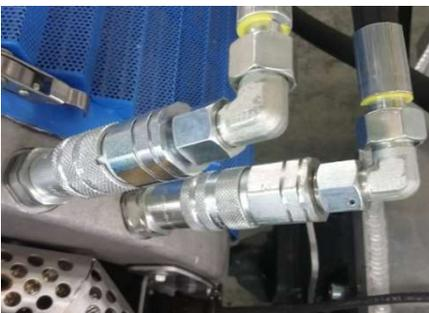
Beide Hydraulikleitungen des Multi-Twisters auf die Anschlüsse am Grundgerät aufstecken. (verwechslungssicher)
