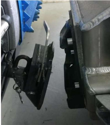
Schnellverschluss-Hebel am Motormäher-Grundgerät schließen, Sicherungsstecker nicht stecken.
