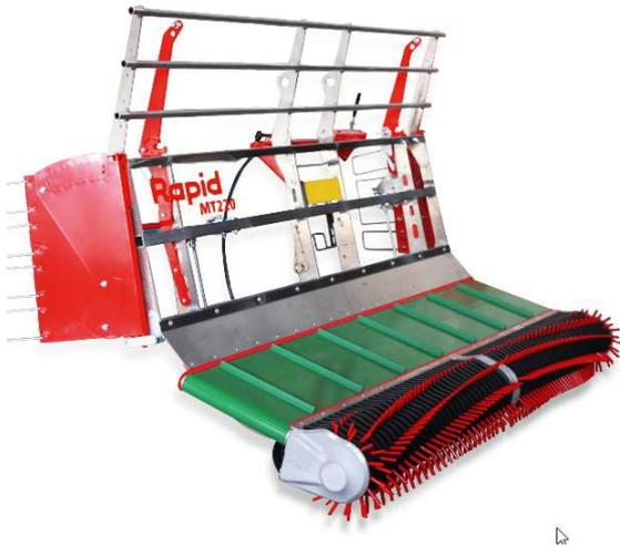
Durch langes Drücken ( $\geq 2$  Sekunden) der Taste „Anbaugerät EIN/AUS“ (4) im Bedienteil des Grundgerätes wird der Multi-Twister ein- bzw. ausgeschaltet. Die Pick-Up läuft bzw. stoppt.
