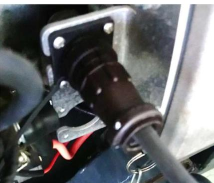
Elektrostecker des Multi-Twisters in die Grundgerät-Frontsteckdose stecken und durch leichtes Drehen verriegeln. Es erscheint folgende Anzeige im Bedienteil:
