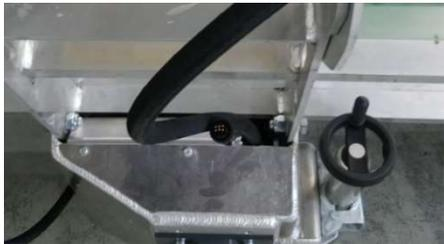
Stützfuß des Multi-Twisters durch Drehen am Handrad vollständig einziehen.
