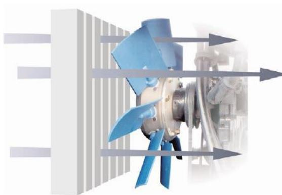
Bei der Betätigung des Steuerschalter ändern die Flügelblätter ihre Winkel wie bei der Abbildung 2 dargestellt so, dass die Luft zurück durch den Kühler geleitet wird, wodurch Schmutz- und Staubpartikel durch die Gebläseumkehr entfernt werden. Die Bedieneinheit erlaubt dem Bediener, die Durchführung weiterer Reinigungszyklen, bei sehr starker Schmutziger und staubiger Umgebung.
