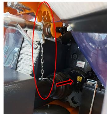
Spannschloss & Sicherungskette der Kardanwelle am Rahmen befestigen und Kardanwelle am Getriebe einhängen.
