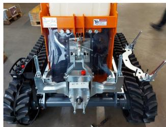
Rapid Aufnahme einhängen & Rasthebel nach oben umklappen.
