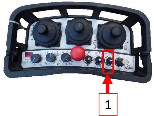
Über den Drehschalter (2) können Sie den Auflagedruck des Anbaugerätes anpassen!
