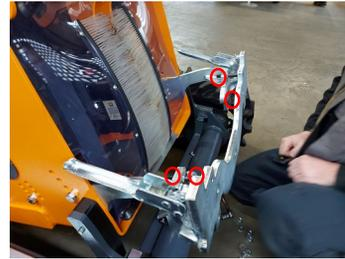
Befestigung **KAT.1 Aufnahme**, über 4 Bolzen und Muttern.
