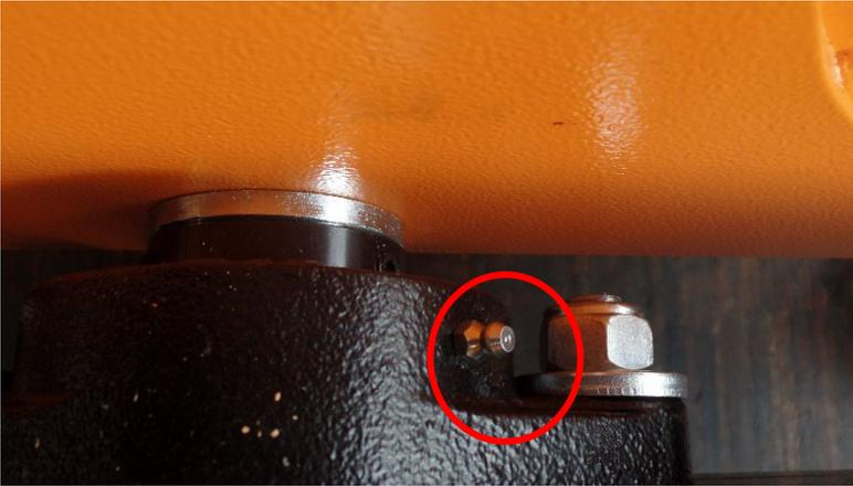
Abschmierung Seitenverschiebung nur bei ausgefahrenem Fahrwerk. Intervall: **jährlich**
