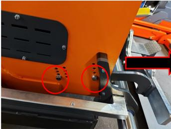
**Originalaufnahme**, lösen durch öffnen der seitlichen Verschraubung am Rahmen.
