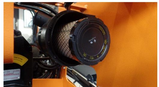
Ziehen sie die Sicherheitskartusche ebenfalls durch leichte Drehbewegung heraus und ersetzen Sie dieses jedes mal, wenn die Hauptkartusche erneuert wird.
