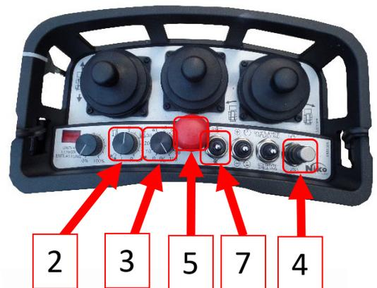
3.) Lösen Sie den Not-Aus Knopf (5) am Sender (Fernbedienung) durch drehen im Uhrzeigersinn
