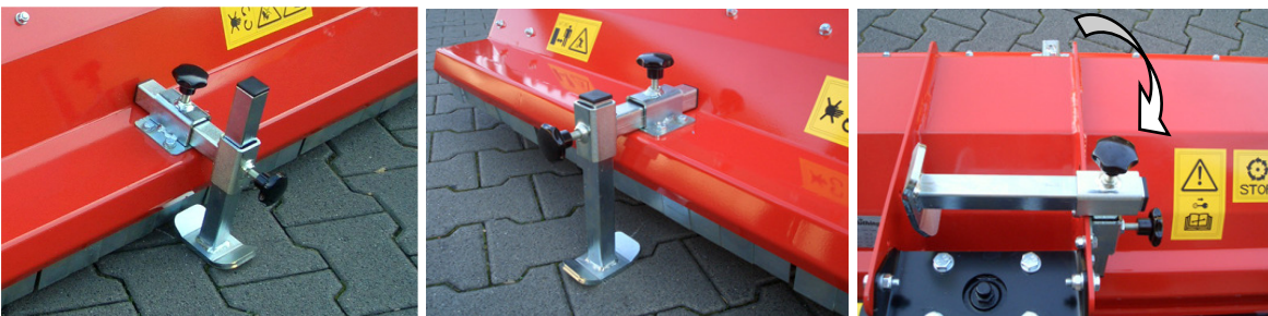
Abbildung 4: Abstellstütze, niedrige, hohe und Arbeitsposition
