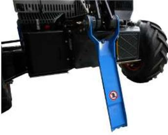
Um die Maschine ohne Anbaugerät sicher abstellen zu können, ist sie mit einer Abstellstütze ausgestattet. Die Abstellstütze kann hoch- und runtergeklappt werden.
