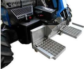
Zum Mitfahren auf der Maschine kann die Option Trittbrett unterhalb des Lenkers montiert werden.
