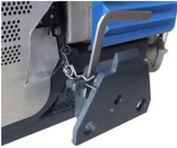
Am Balkenzapfen befindet sich ein Schnellverschluss-Hebel zum einfachen An- und Abkoppeln der Anbaugeräte.
