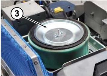
c) Luftfilter (3) und Schaumstofffilter reinigen.
