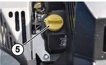
f) Motoröl-Einfüllstutzen (5) verschließen.
