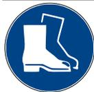
Sicherheitsschuhwerk mit Stahlkappe und durchtrittsicherer, ölfester Sicherheitssohle.
