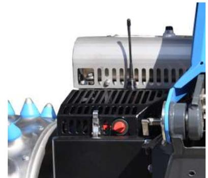
Über die Funkfernsteuerung lassen sich alle wichtigen Funktionen der Maschine und der Anbaugeräte aus bis zu 100 Metern Entfernung steuern. Falls die Funkfernsteuerung über ein Display verfügt, werden die Zustandsdaten von der Maschine angezeigt.
