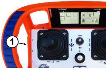
a) Taster "Fahrstufe -/G-" (1) kurz drücken.
