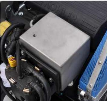
Der Ölnebelabscheider sammelt die bei der Kurbelwellen-Entlüftung mitgerissenen Öltröpfchen und führt das Öl dem Verbrennungsmotor wieder zu. Die abgashaltige Luft wird über das Luftfiltergehäuse zur Verbrennungsluft hinzugemischt.
