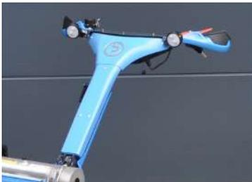
Oben am Lenkholm befinden sich das Bedienteil und die Griffe. Der Lenkholm kann in unterschiedliche Positionen gestellt und individuell auf den Bediener angepasst werden:
