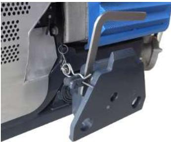
Am Balkenzapfen der Maschine wird das Anbaugerät mittels Fangschale an- und abgekoppelt.
