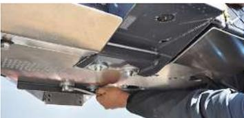
Optional kann ein Unterfahrerschutz montiert werden als Schutz vor Beschädigungen von unten. Der Unterfahrerschutz ist auch an älteren Maschinentypen nachrüstbar.
