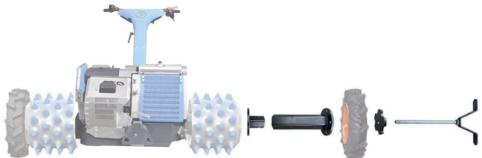
Für Doppelbereifungen sind verschieden Varianten von Schnellwechselsystemen verfügbar.
