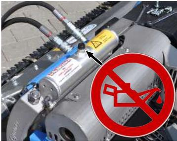
Im Betrieb erwärmt und dehnt sich das Hydrauliköl aus. Das größere Volumen wird vom Hydrauliköl-Ausgleichsbehälter aufgenommen.
