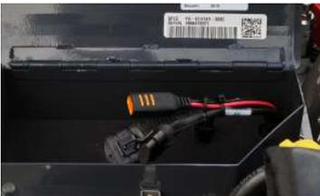
Im Werkzeugkasten (1) befindet sich eine Werkzeutasche (2) mit einer Auswahl des benötigten Werkzeugs, der Anschlussstecker zum Laden der Batterie, der Diagnosestecker, die Anschlüsse für die Funkfernsteuerung und elektrische Sicherungen.
