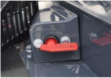
Der Batterietrennschalter dient der Trennung der Masseverbindung zwischen Batterie und Maschine. Um die Maschine in Betrieb nehmen zu können, muss der Batterietrennschlüssel eingesetzt und um 90° gedreht werden.
