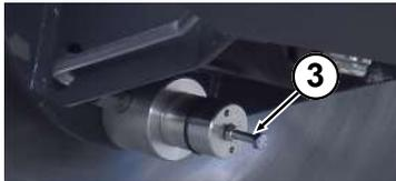
c) Sechskantmutter drehen, bis die Kolbenstange bis zum Anschlag zurückgezogen ist.
