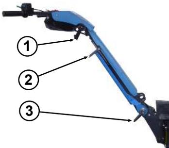
Am Lenker befinden sich drei Spannhebel zur Einstellung der Lenkerposition in Höhe, Länge und Winkel Oberteil / Bedienteil (siehe auch Kapitel *Lenker einstellen* [▶ 46]).
