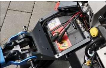
Die Batterie befindet sich im Batteriekasten unterhalb des Werkzeugkastens.
