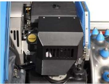
Optional kann eine Schutzabdeckung über der Kraftstoffpumpe montiert werden. Diese schützt die Pumpe und empfindliche Bauteile wie Kabel, Stecker und Schläuche vor mechanischer Beschädigung.
