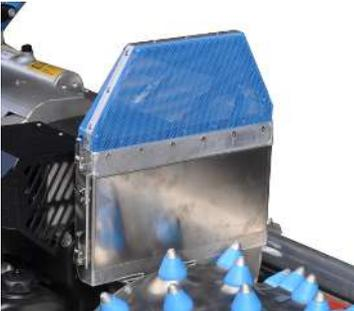
Optional kann ein Verlängerungsteil zwischen dem Ansaugkasten am Motor und dem Luftansauggitter ohne Werkzeug montiert werden. Durch die erhöhte Position verschmutzt das Ansauggitter weniger.
