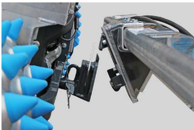
Abb. 7.: Schnellverschluss und Fangschale bei Mähwerk mit Alurahmen (2,60 m bis 4,30 m)
