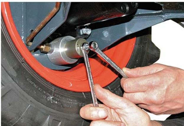
Abb. 3.: Radbremszylinder entsperren
