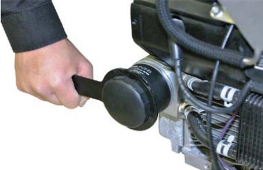
Abb. 25.: Motorölfilter abschrauben
