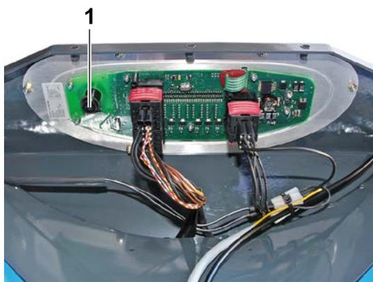
Abb. 16.: Rückseite Cockpit-Display
