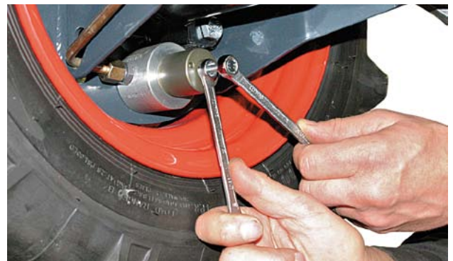
↑ Fahrtrichtung Drehschieber ⊖ Position „Fahrbetrieb“ ⊕ Position „Leerlauf“
