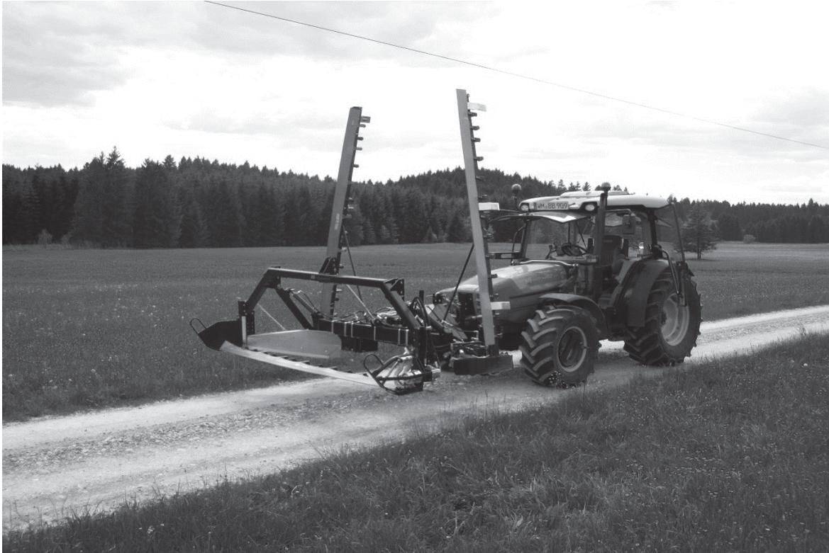
**Achtung: Die Fronthydraulik darf niemals in Schwimmstellung sein, der Abstand Rahmenunterkante-Bodenoberkante muss 580mm betragen, bzw. der erste Zylinder sollte ca. 100mm herausgeschoben sein.**
