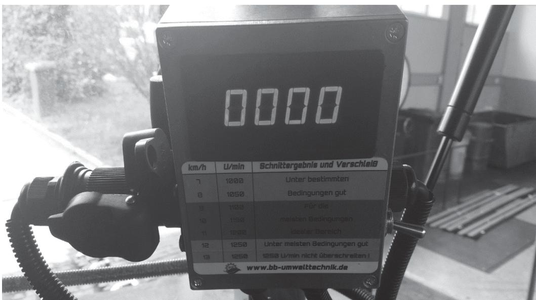
**Drehzahlmesser (falls vorhanden) an 3 poligen Stecker anschließen und einschalten, bei Drehzahlabfall sofort Maschine ausschalten!!!!**
