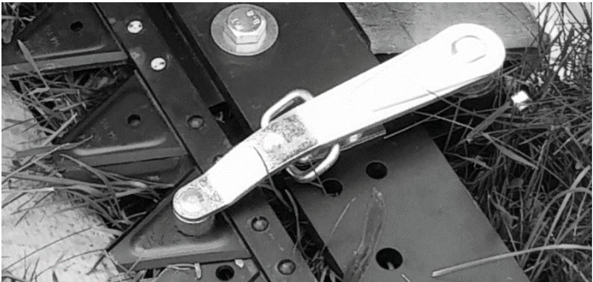
**ACHTUNG: Bei jedem Messerwechsel, bzw. nach 12 Betriebsstunden Führungszapfen einfetten!!**
