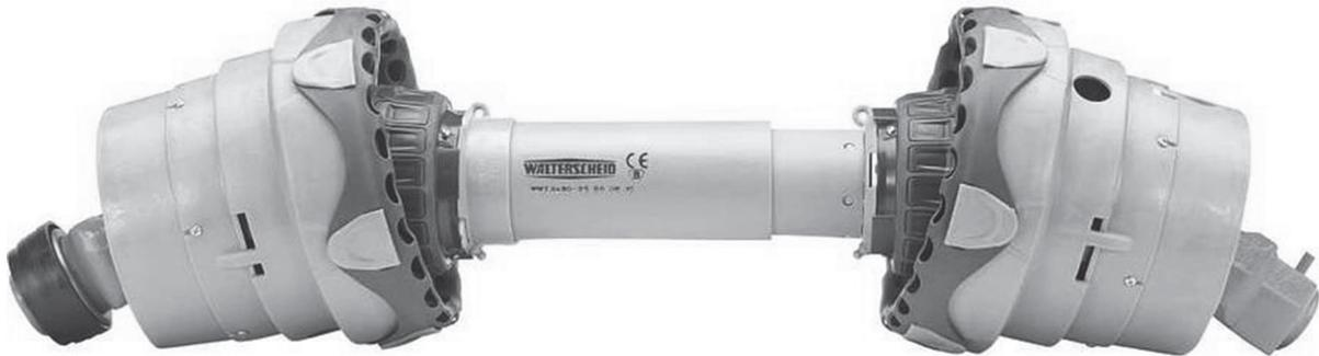
**Aufrichtige Zapfwellendrehzahlachten (Frontmäherwerk max. 650U/min, Heckmäherwerk max. 350U/min-bei Standardgetrieben) und Schmierintervalle einhalten!**
