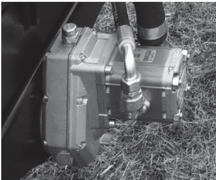
**Achtung: Ölstand im Übersetzungsgetriebe prüfen!**
