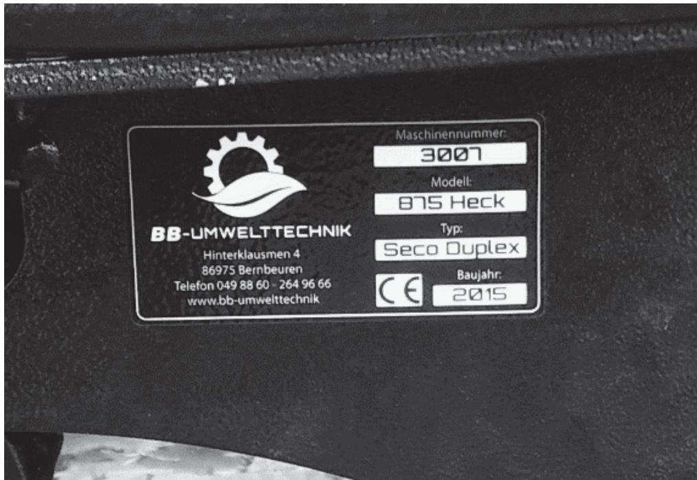
Die Fabriknummer ist auf dem nebenstehend gezeigten Typenschild und am Rahmen eingeschlagen. Garantiefälle und Rückfragen können ohne Angabe der Fabriknummer nicht bearbeitet werden. Bitte tragen Sie die Nummer gleich nach Übernahme des Fahrzeuges/Gerätes auf der Titelseite der Betriebsanleitung ein.
