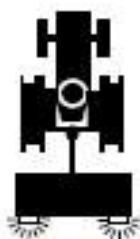
Anhänge-Arbeitsgeräte (mit Zugdeichsel) müssen mit einer eigenen Beleuchtungseinrichtung ausgerüstet sein.
