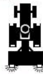
Arbeitsgeräte mit Dreipunktbau müssen mit einer eigenen Beleuchtungseinrichtung ausgerüstet sein:
