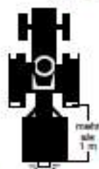
Arbeitsgeräte mit Dreipunktbau müssen mit einer eigenen Beleuchtungseinrichtung ausgerüstet sein:
