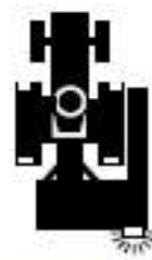
Arbeitsgeräte mit Dreipunktbau müssen mit einer eigenen Beleuchtungseinrichtung ausgerüstet sein:
